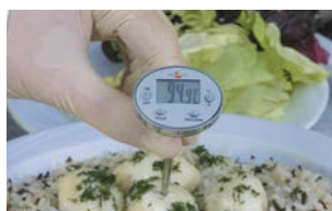
Pro namátkové kontroly teploty v potravinářské výrobě.
